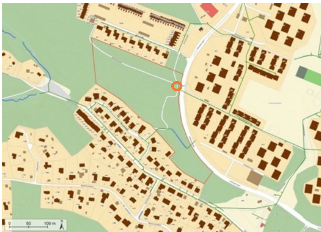
Figur 6. Befintliga dagvattenledningar (gröna linjer) och diken (blå linjer) i anslutning till utredningsområdet Ampere (avgränsat i rött). Orange ring markerar ungefärlig placering av befintliga dagvattenbrunnar. Bakgrundskarta: Nacka kommuns webbkarta
